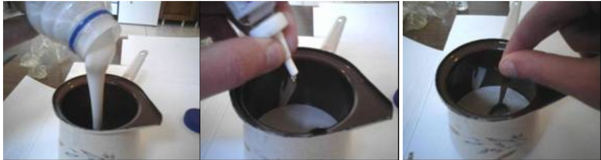
Slika 6. Miješanje dvije komponente TEKASIL 2k Z010 silikonske mase.
