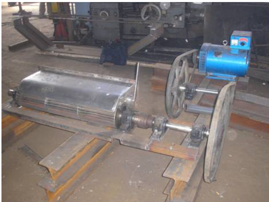
Slika 4: Montaža turbine, prenosnog mehanizma i generatora u radionici Metalno d.d. Zenica
