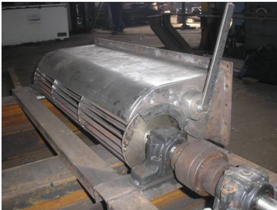
Slika 3: Montaža rotora i mlaznica turbine
