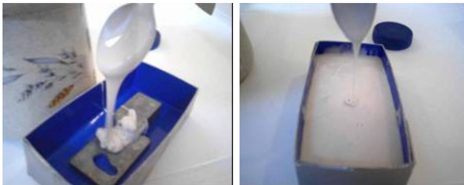
Slika 7. Livenje silikonske mase preko modela.
