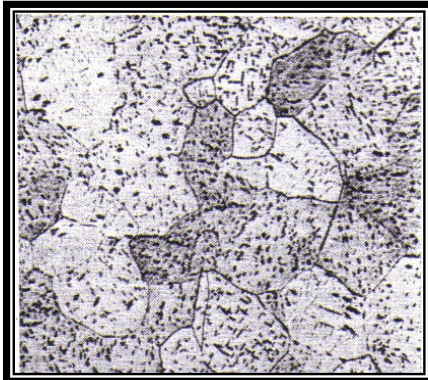
Struktura \alpha legure 100x
