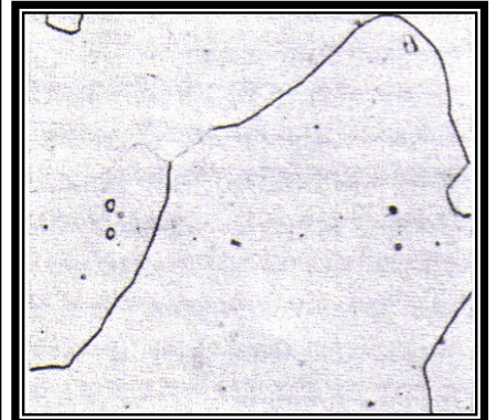
Struktura nestabilne \beta legure polako hlađene u \beta polju 250x
