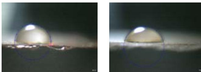
**Slika 6.** Ugao kvašenja za prevlaku A pre (leva slika) i nakon zračenja (desna slika)
