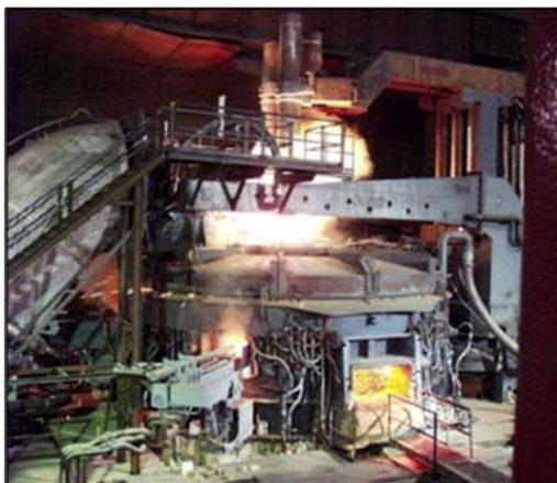
Slika 6. Izgled elektropeći
